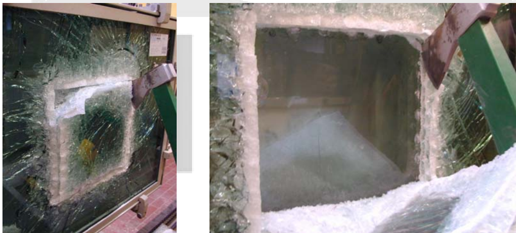
Secuencia de apertura de paso de hombre en el ensayo de ataque con hacha
