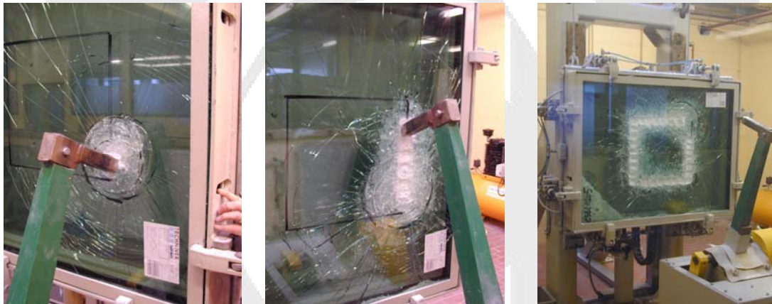
Secuencia de rotura del primer vidrio con el impactador
